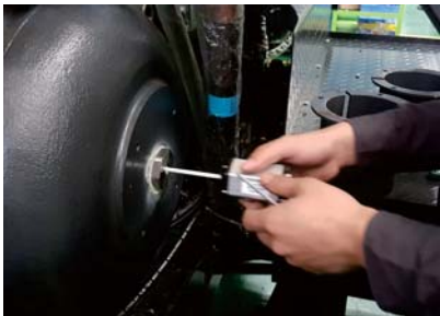
耐压外管无需与液压缸分离
